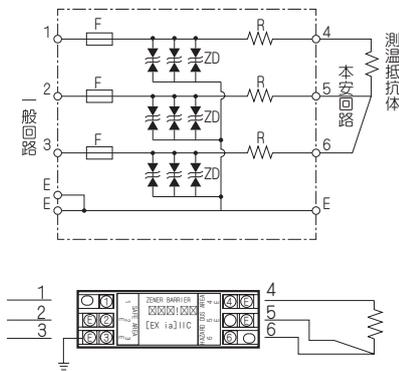
測温抵抗体温度計装置において、安全保持器(バリア)を使用する場合・バリアを使用する場合、一般機器(温度表示器、温度調節計等)と検出器を接続する外部配線の配線抵抗にバリア内部抵抗 75 Ω も含まれる事になりますので、一般機器の外部配線許容抵抗値に注意してください。許容抵抗値を超えると温度測定誤差が発生します。従いまして、バリアに接続する一般機器は外部配線許容抵抗値 100 Ω 以上の機器を使用してください。
