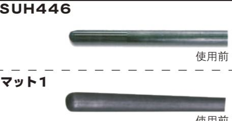
産業廃棄物焼却施設(二次燃焼室、約900°C)にて、継続的に寿命(断線、交換までの期間)調査を実施しました。その結果、『マット1』は通常のSUH446保護管に比べて、約3倍の寿命を示しました。
